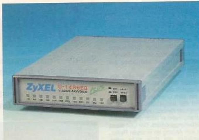
Das ZyXEL U1496EG+ bietet einen ZyXEL-eigenen Modus mit 19200 bps, "versteht" aber auch normale Highspeed-Modems
