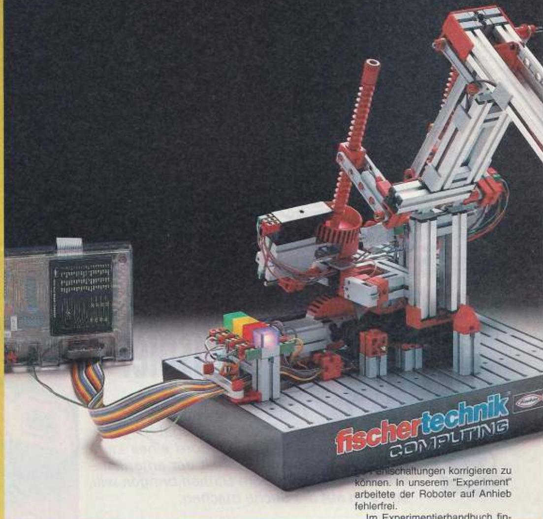
werden. Hier entpuppt sich die Bauanleitung dann allerdings als wenig hilfreich. Das 20-Pin-Flachbandkabel, das den Schweißroboter über das Interface mit dem Computer verbindet, ist zwar farblich codiert, die einzelne Zuordnung der Leitungen aber unzureichend beschrieben, was dann auch leicht zu einiger Verwirrung führt. Gerade für den elektrischen Anschluß ist große Sorgfalt notwendig.
